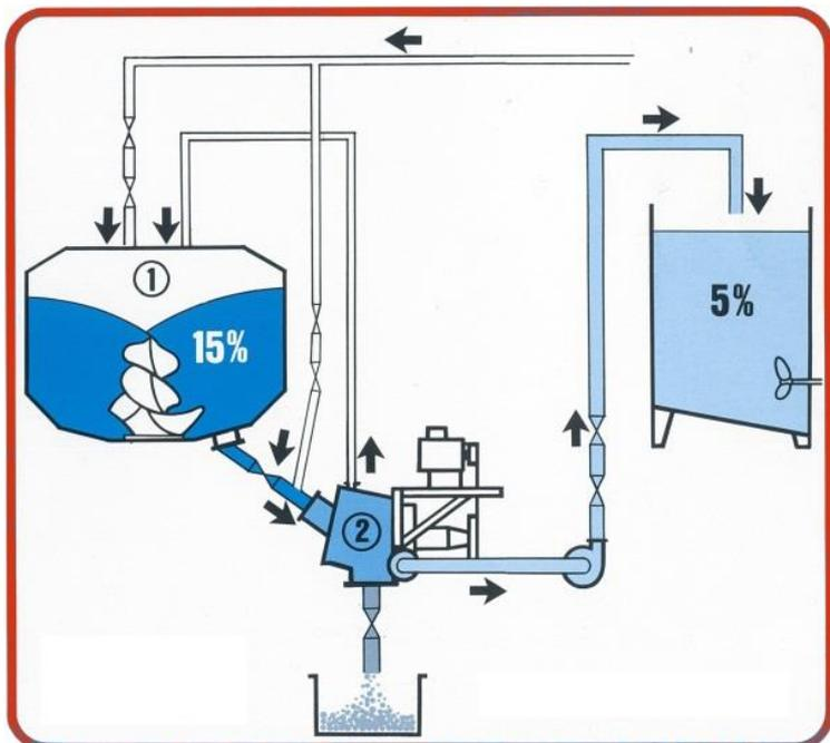
En el Dumpulper los contaminantes, que no pueden atravesar la rejilla, se van almacenando en el fondo mientras la pasta atraviesa la rejilla y es aspirada por la bomba de vaciado. Un rotor con varias palas de acción progresiva aparta los contaminantes para evitar que la rejilla se tapone.
